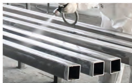
Напыление цинкосодержащего грунта
